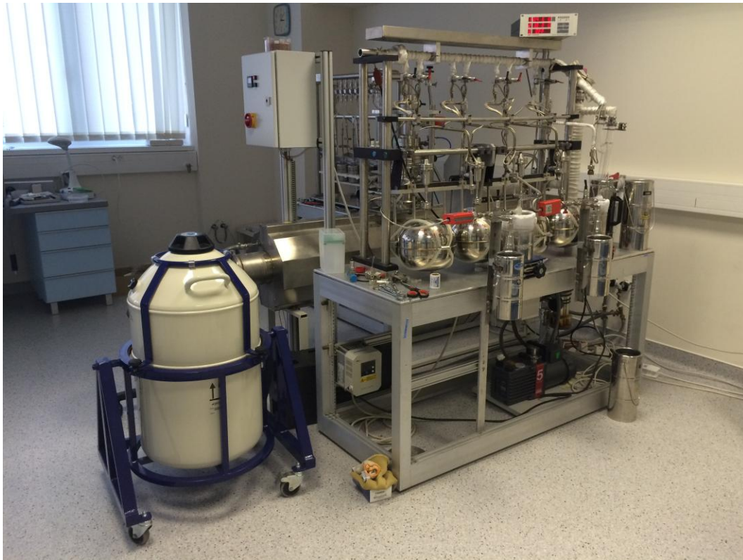
3. ábra A homoktalajoknál alkalmazott vákuum desztillációs rendszer (fotó: Kompár László, 2014)
